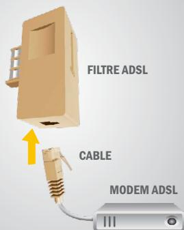
**1** Raccorder le câble du modem au filtre ADSL
